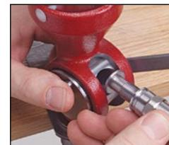
Die Dosierschraube des Pulverfüllgerätes lässt sich auf Knopfdruck, ohne Verlust der Einstellung, austauschen.
