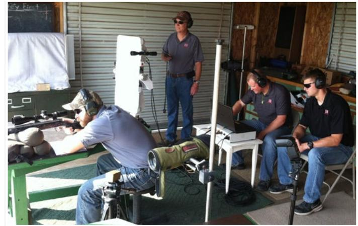
Hornady® Ingenieure benutzen ein Doppler-Radar, um die Effekte der aerodynamischen Hitzeeinwirkung zu erforschen und um die Effizienz der Heat Shield-Spitze zu dokumentieren.
