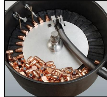
*Der Pistol Bullet Feeder arbeitet nicht mit Blei- oder beschichteten Geschossen.*
