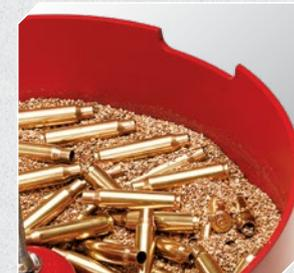
Das Tumbler-Gefäß ist für ein einfaches Sieben und Reinigen mit einer Schüttöffnung versehen.
