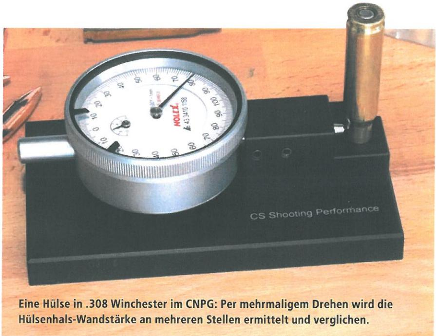
Eine Hülse in .308 Winchester im CNPG: Per mehrmaligem Drehen wird die Hülshals-Wandstärke an mehreren Stellen ermittelt und verglichen.
