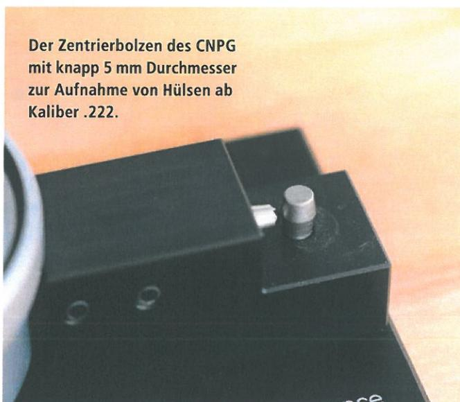
Der Zentrierbolzen des CNPG mit knapp 5 mm Durchmesser zur Aufnahme von Hülsen ab Kaliber .222.
